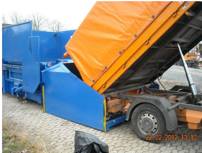
Abfallpresse mit Hubkippvorrichtung
